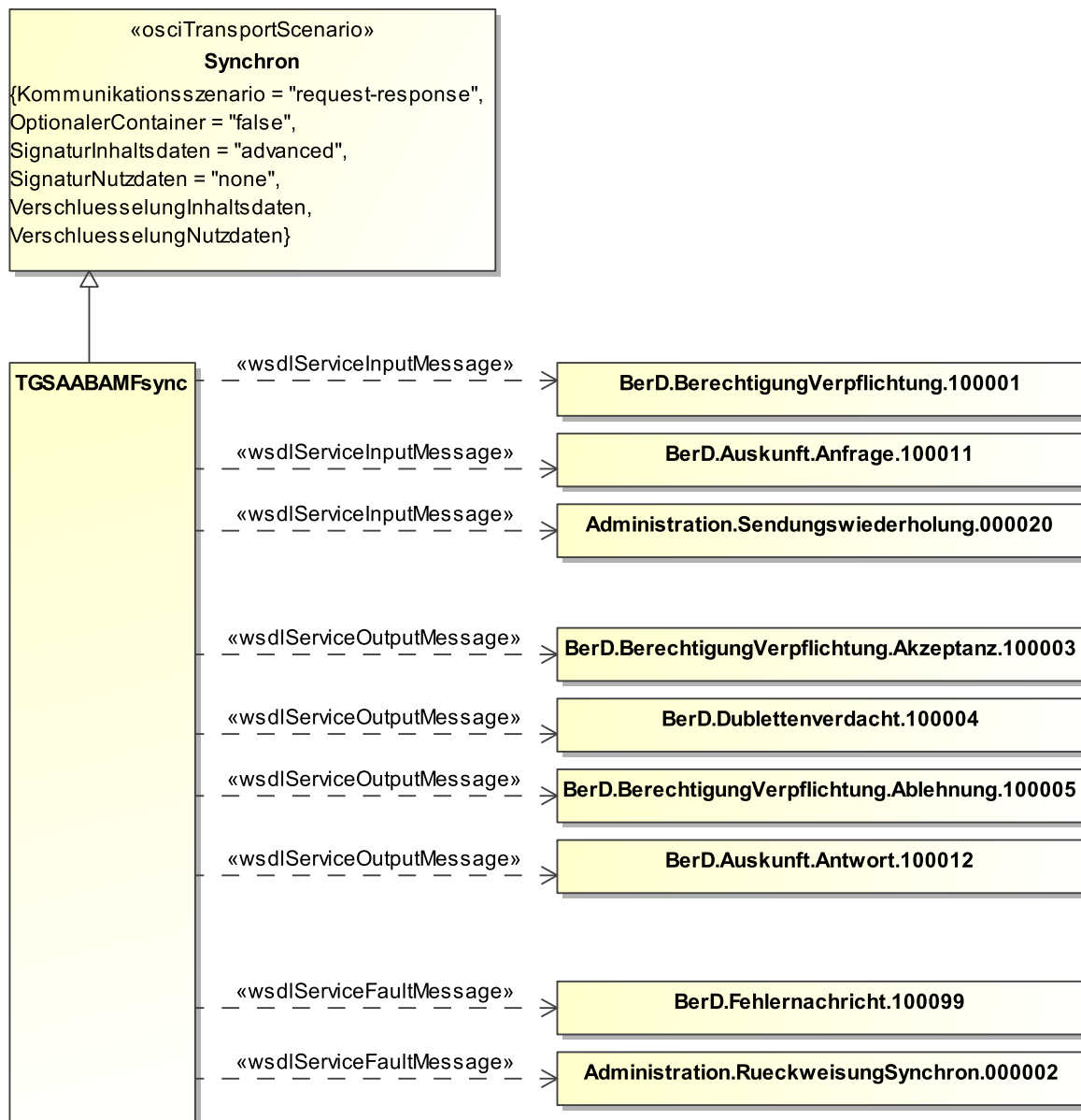
Abbildung C.7. Nachrichten zur synchronen Verwendung
